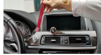
3. Loosen the left AC outlet.
